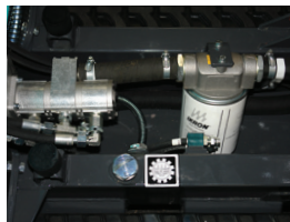
Réservoir d'huile hydraulique incorporé au châssis
