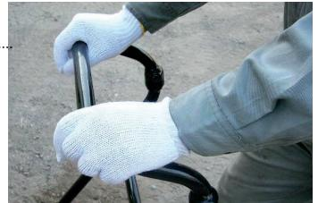
Les plaques vibrantes série VAS sont équipées d'un système anti-vibrations qui réduit de plus de 50% les vibrations transmises dans le bras de l'utilisateur.
