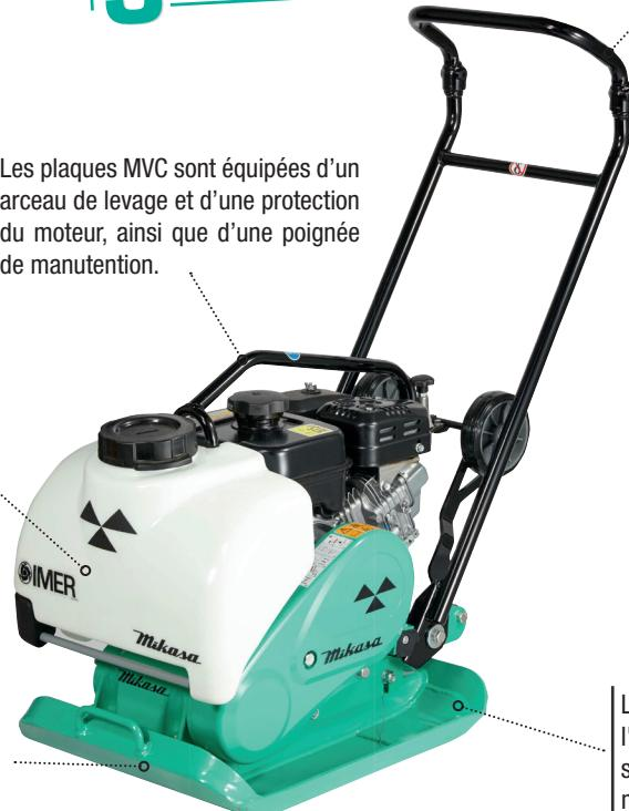
Grâce à ses bords recourbés, la semelle ne marque pas l'enrobé. Elle offre un meilleur glissement et un compactage complet de la superficie.
