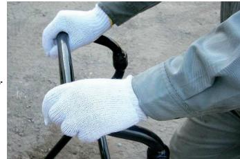
Les plaques vibrantes série VAS sont équipées d'un système anti-vibrations qui réduit de plus de 50% les vibrations transmises dans le bras de l'utilisateur.
