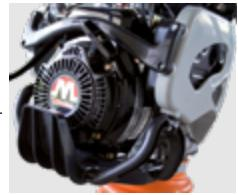
Protection intégrale du moteur avec coque ABS
